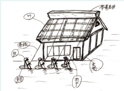
1-3-23 屋根を竹で押さえ、南からの強風に備え 番線を張った様子 (地元住民の作画)
