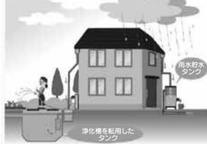
※1つの浄化槽で約1000リットルの雨水を貯めることができ、新川流域で今後10年間下水道へ接続する家庭で浄化槽を雨水貯留浸透施設へ転用すると、約5万㎡の雨水を貯留することができます。
