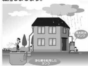
※1つの浄化槽で約1000リットルの雨水を貯めることができ、新川流域で今後10年間下水道へ接続する家庭で浄化槽を雨水貯留浸透施設へ転用すると、約5万㎡の雨水を貯留することができます。
