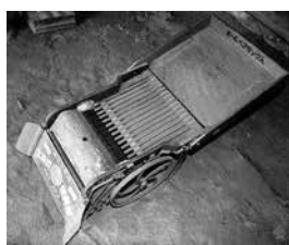
はが取機（ケバ取機） 繭の出荷前にハンド ルを回して表面の毛 を取り除く。
