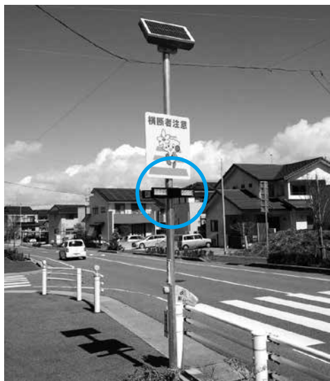
歩行者がボタンを押すと○の部分明るく点滅することでドライバーに歩行者の存在と横断する意思を示す装置です
