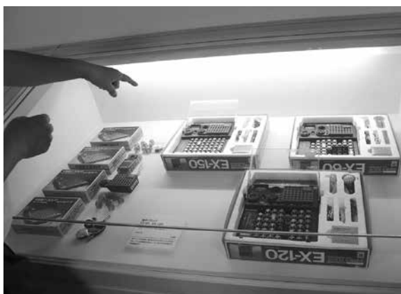
▲電子ブロック 電子回路を組んで実験がおこなえる電子玩具
