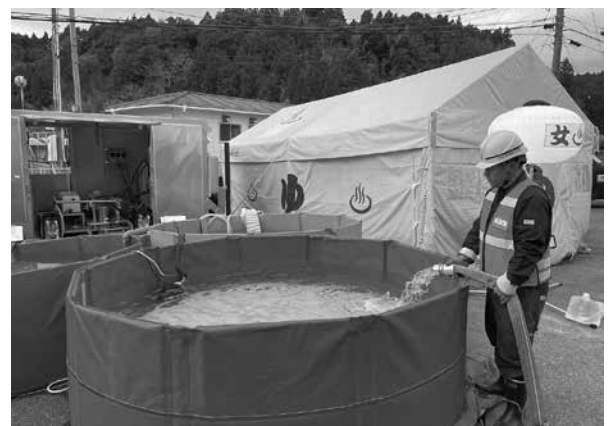
仮設風呂用の水 自動的に汲み上げお湯を沸かします
