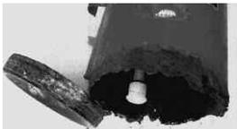
消火器本体容器の耐用年数は、概ね8年（消火器工業会）とされていますが、雨ざらしの所や厨房など、湿気の多いところに設置しているため、容器が錆びて操作機能にも影響を与えます。破裂事故の原因となっている消火器は、ほとんど点検もされず、長期間放置された古い消火器に集中しています。
