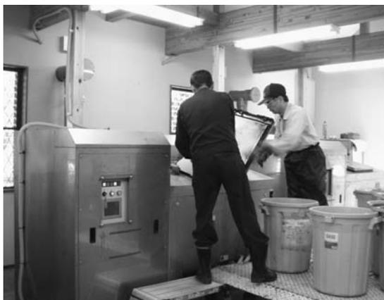
毎週2回、河北区内を回ってポリバケツを回収。3基ある堆肥化処理装置に生ごみを投入すると、1週間ぐらいで一次発酵の堆肥に＝10月2日、河北エコステーションで
