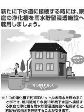
新たに下水道に接続する時には、家庭の浄化槽を雨水貯留浸透施設へ転用しましょう。
