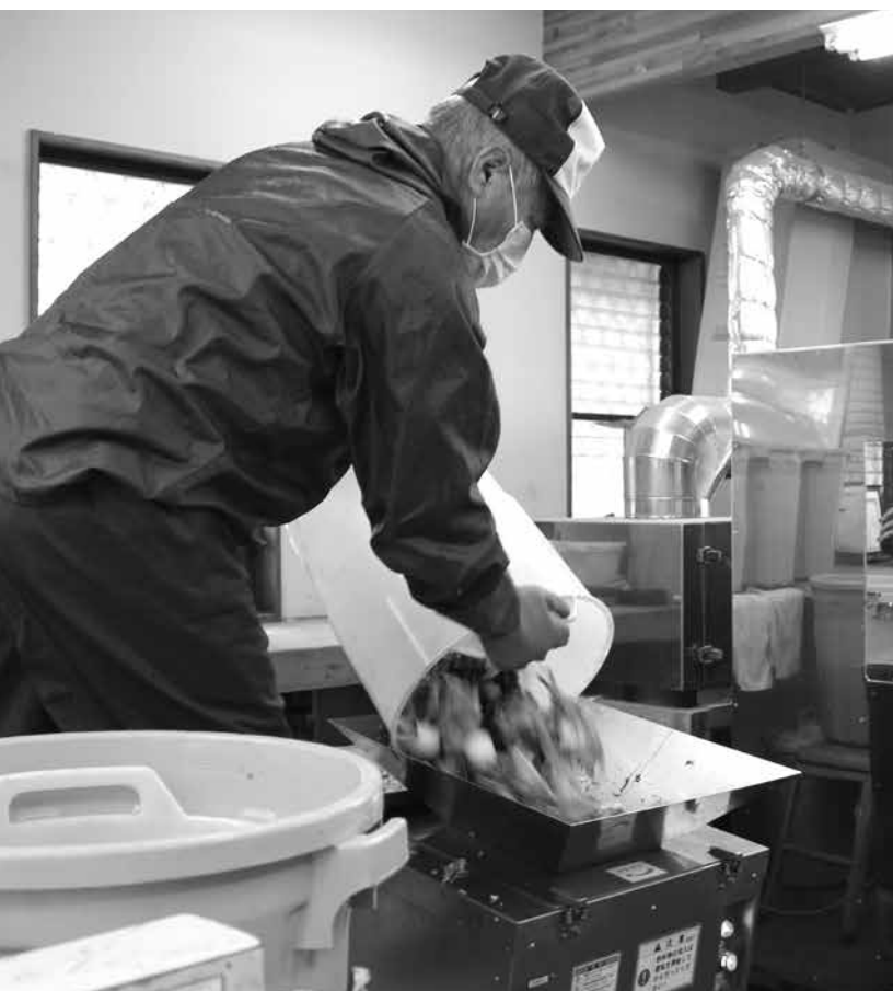
▲回収した生ごみを河北エコ・ステーションのかくはん機に投入する作業
