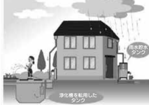
※1つの浄化槽で約1000リットルの雨水を貯めることができ、新川流域で今後10年間で下水道へ接続する家庭で浄化槽を雨水貯留浸透施設へ転用すると、約5万㎡の雨水を貯留することができます。
